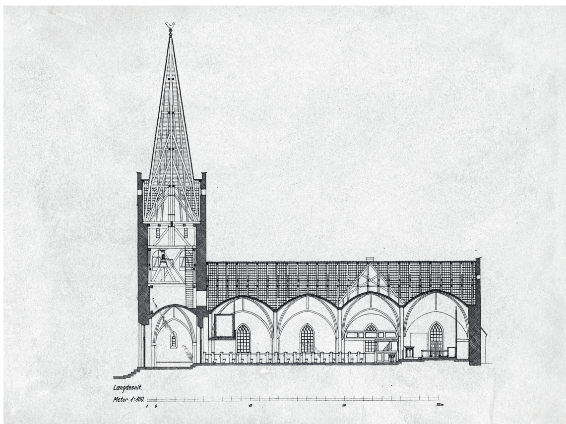
Fig. 27e. Opmåling af kirken. Målt og tegnet af Jørgen Ejlers 1940. 1:400. e. Længdesnit set mod nord. I Svaninge Folkemindesamling. – Scale drawing of the church, 1940. e. Longitudinal section looking north.
